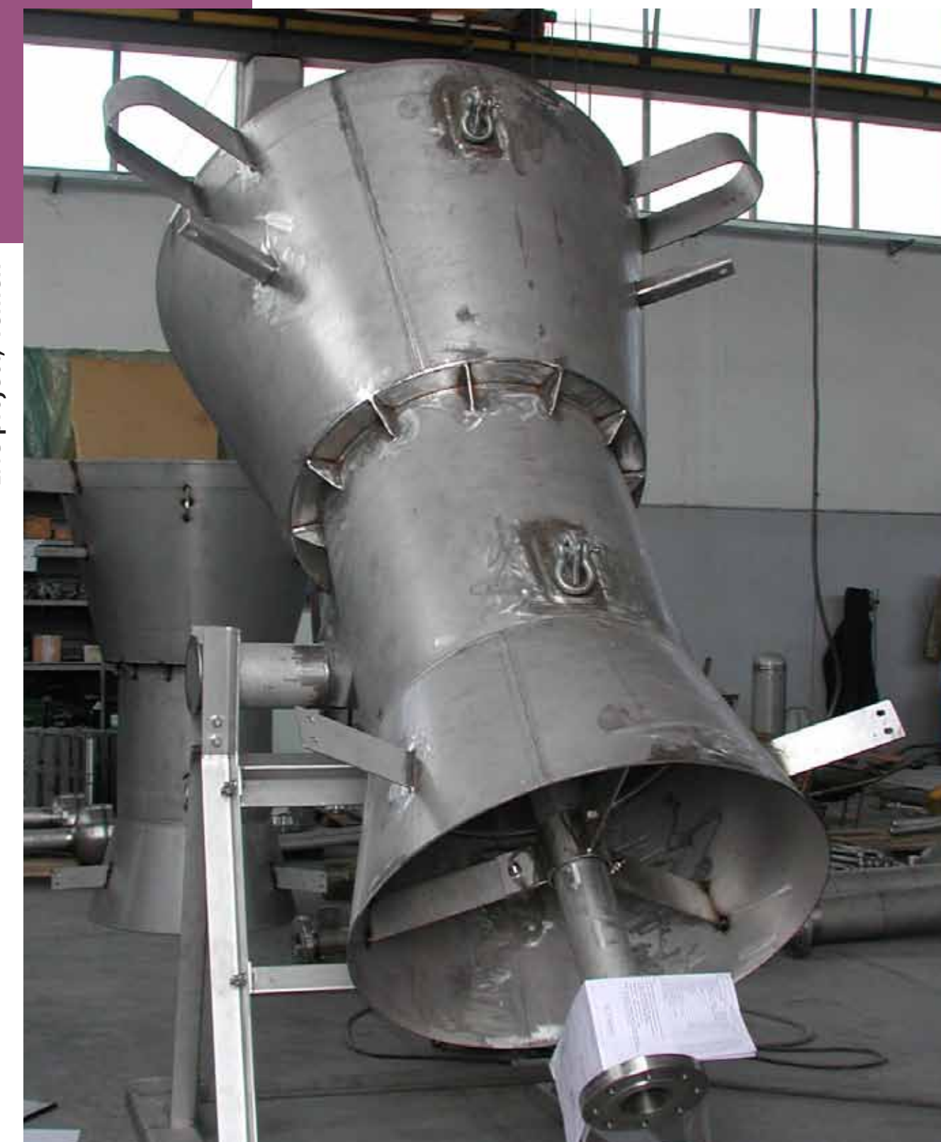
GLNG-80 LNG Liquid Burner LNG project, Yemen
